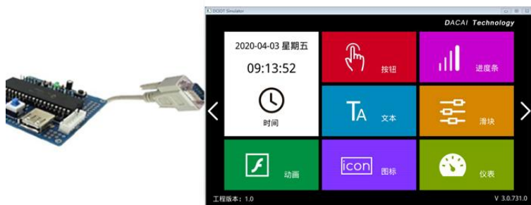
图 9-2 用户单片机串口与“虚拟串口屏”联机调试
